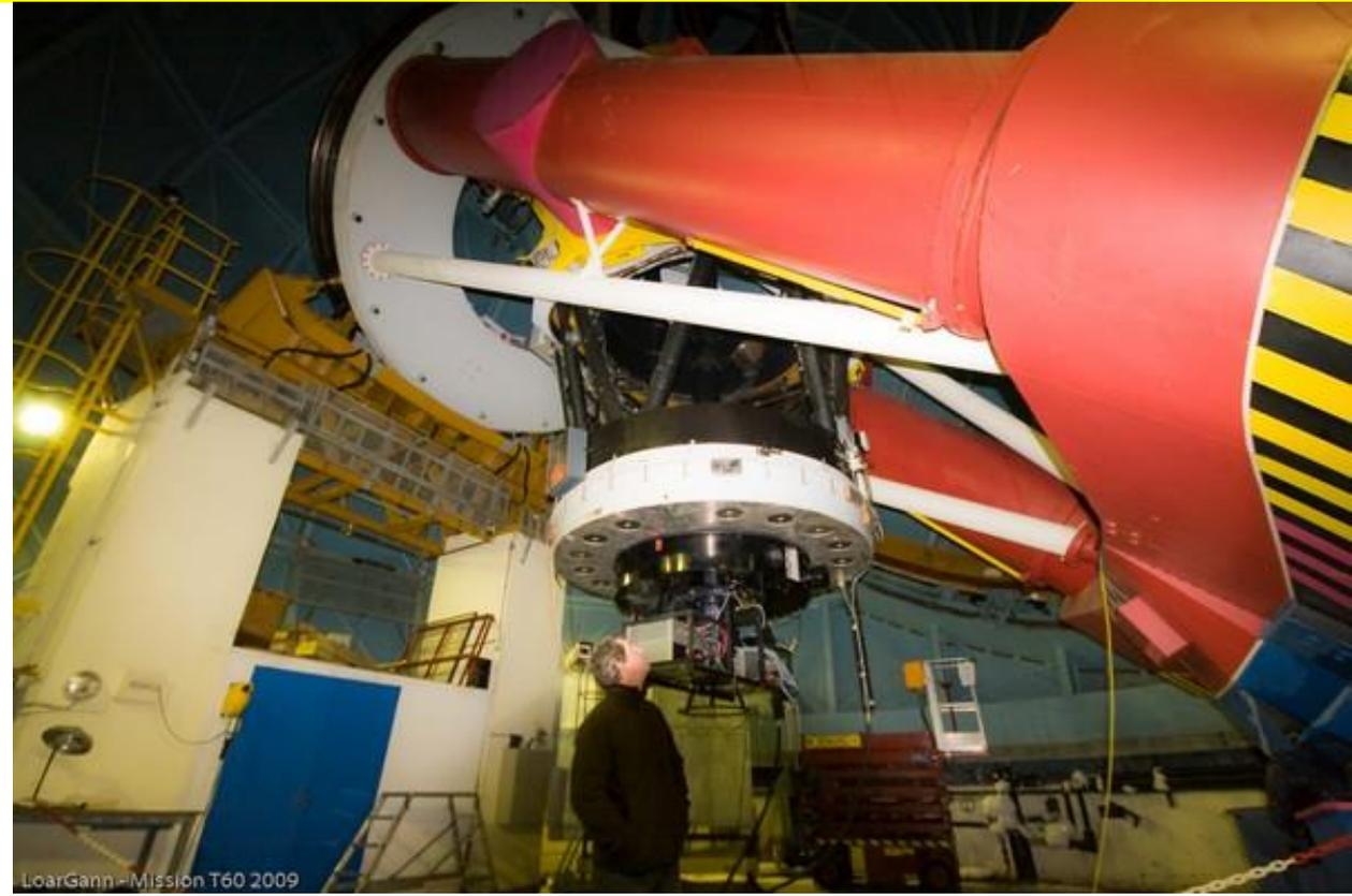
**Le télescope Bernard Lyot (l'inventeur du coronographe), observatoire du Pic du Midi est installé dans une monture à berceau en fer à cheval**
