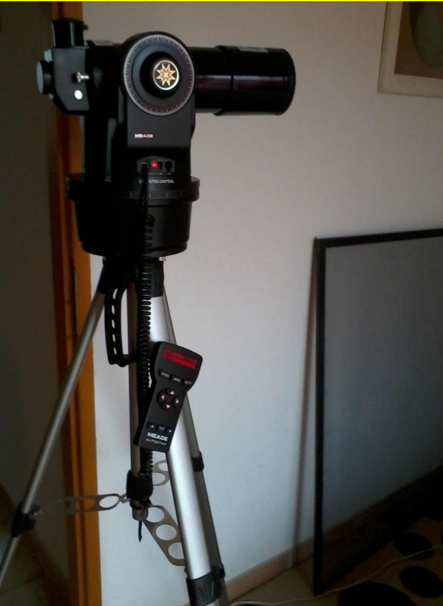
Cette monture azimutale motorisée permet de suivre un astre par un mouvement en escalier qui ne respecte pas le redressement angulaire de l'astre observé. Il en résulte une rotation du champ. Pour pouvoir l'utiliser en photographie il faut insérer un dérotateur de champ entre le porte oculaire et la caméra qui redressera le champ comme avec une monture équatoriale.
