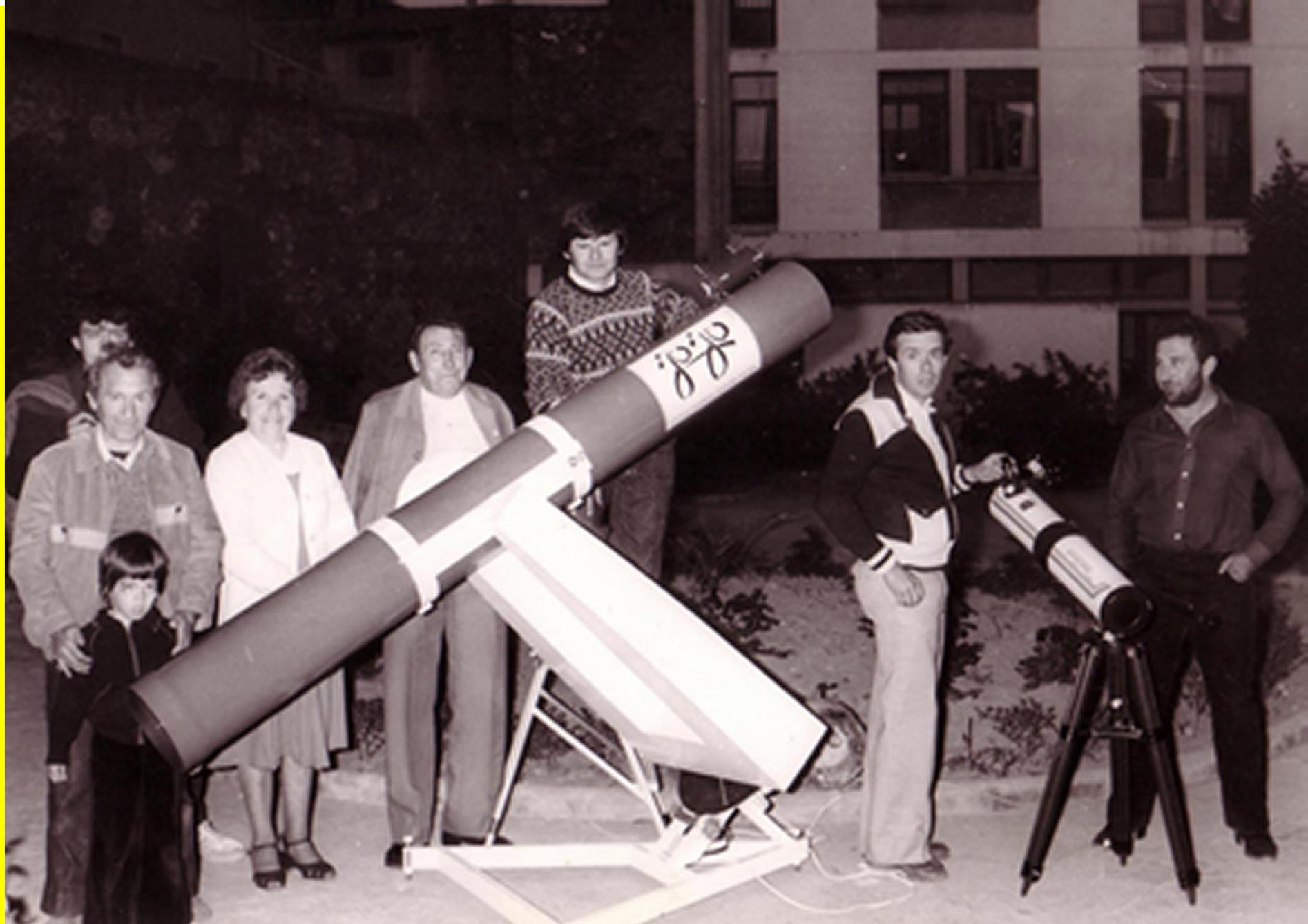
La première monture à fourche de l'ANAP supportant le tube du télescope JOJO (formule de Newton)
